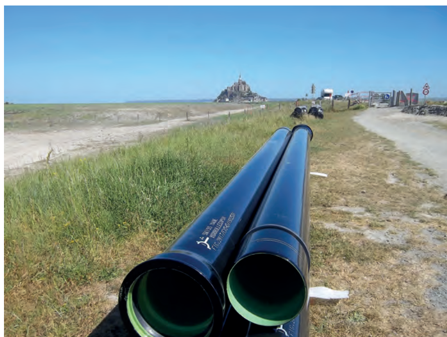
Geocopur de Von Roll Hydro résiste bien aux milieux salins.
